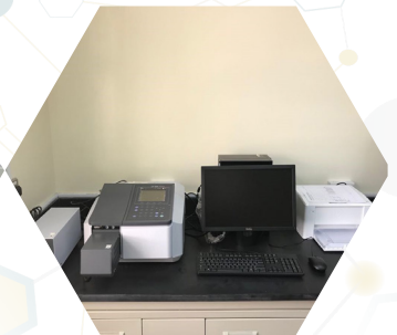
جهاز قياس طيف الأشعة فوق البنفسجية والظور المرئي بمثبت حراري
